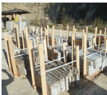
Fertig bearbeitete Werksteine, bereit zum Transport auf die Baustelle
